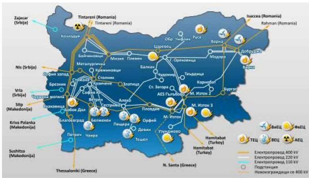
Фиг. 14: Електропреносна система на България, Източник: официален сайт на Електроенергиен системен оператор
