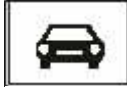
T6 Пътно превозно средство, за което се отнася действието на пътния знак
